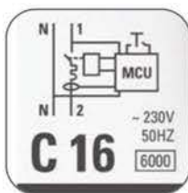
Встроенная защита от аварийных сверхтоков короткого замыкания и токов перегрузки
