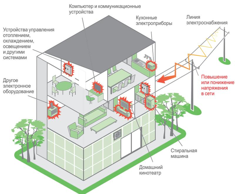
Реле напряжения Resi9 – это автономное устройство для обнаружения повышенного или пониженного напряжения. Размыкание цепи происходит внутри реле, а когда сеть возвращается в нормальное состояние, цепь снова автоматически замыкается.
