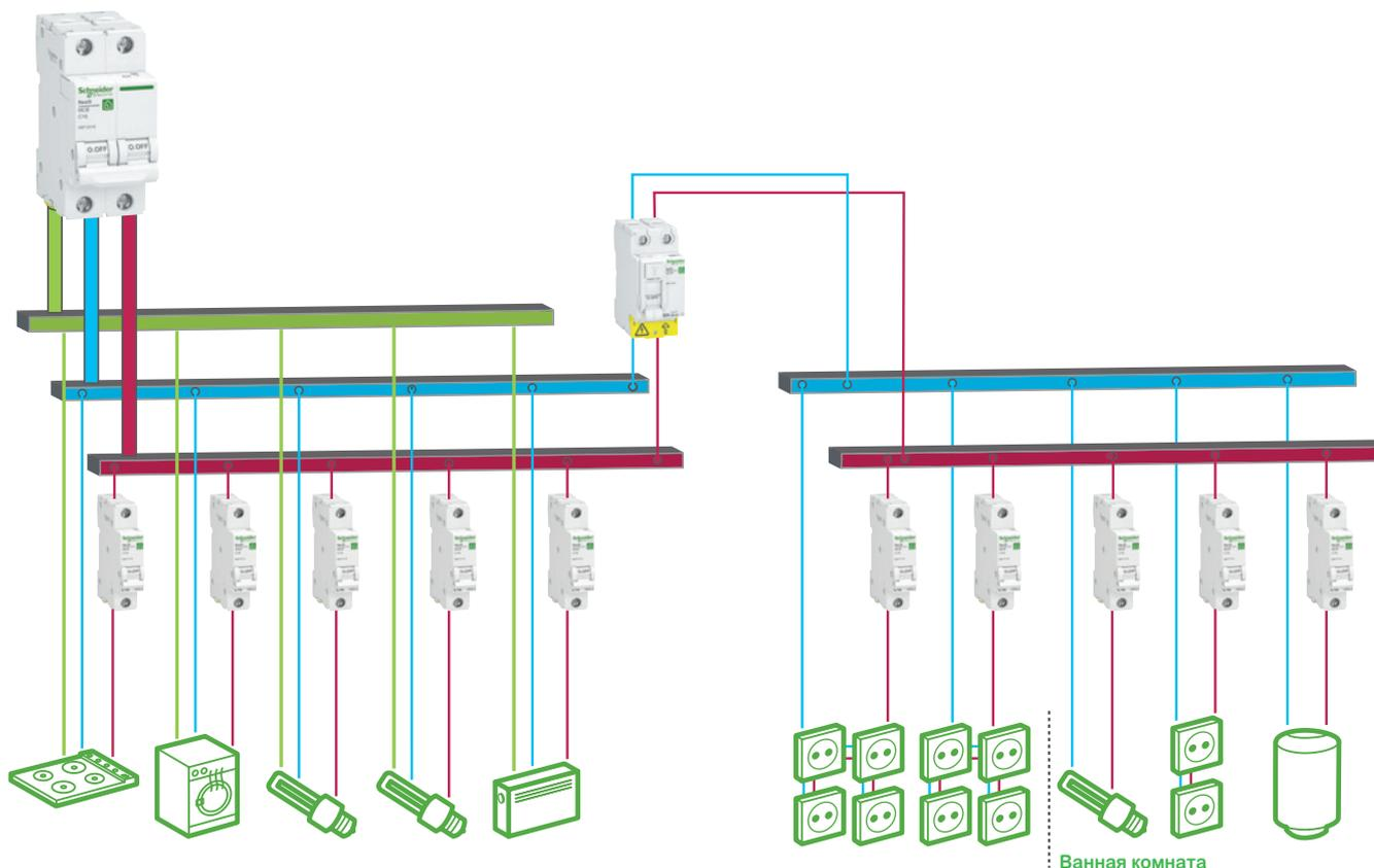
В соответствии с нормативными требованиями один выключатель дифференциального тока (ВДТ) может обеспечивать защиту всех розеток и всего электрооборудования в ванной комнате.
