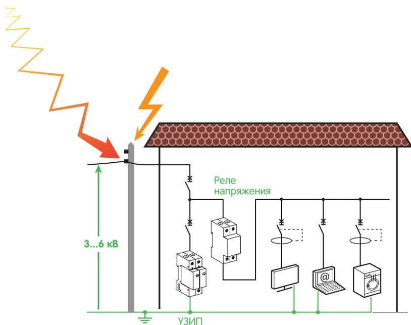
Устройство защиты от импульсных перенапряжений (УЗИП) ослабляет скачок напряжения до значения, выдерживаемого подключенными приборами (до 1,3 или 1,5 кВ, см. значения уровня защиты от перенапряжений ( $U_p$ )).
