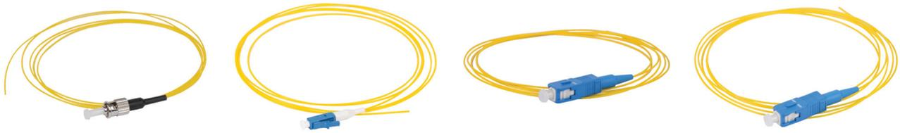
Оптические монтажные шнуры или по-другому пигтейлы (в простонародье - пороссячий хвостик) представляет собой отрезок кабеля, оконцованный с одной стороны разъемом, второй конец соединяется с волокном с помощью сварки. Длина наших пигтейлов составляет 1,5м. Существуют также одномодовые и многомодовые пигтейлы, одномодовые имеют внешнюю оболочку желтого цвета, многомодовые – оранжевого.
