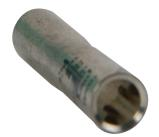
Гильзы служат для соединения и ответвления пайкой или опрессовкой проводов и кабелей на напряжение до 10 кВ с медными жилами номинальным сечением от 1,5 до 400 мм $^2$ .
