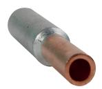
Служат для соединения и ответвления пайкой или опрессовкой проводов и кабелей на напряжение до 10 кВ с медными жилами номинальным сечением от 16 до 185 мм² и с алюминиевыми жилами сечением от 25 до 240 мм<sup>2</sup>.
