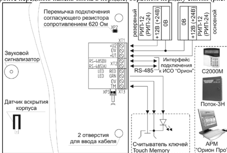
Рисунок 3. Схема внешних соединений блока «Поток-БКИ»
