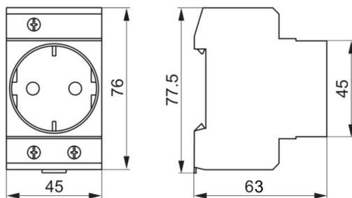
Рис.1 Розетка AC220V (габаритные размеры)
